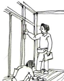
柱や床の傾きの調査
